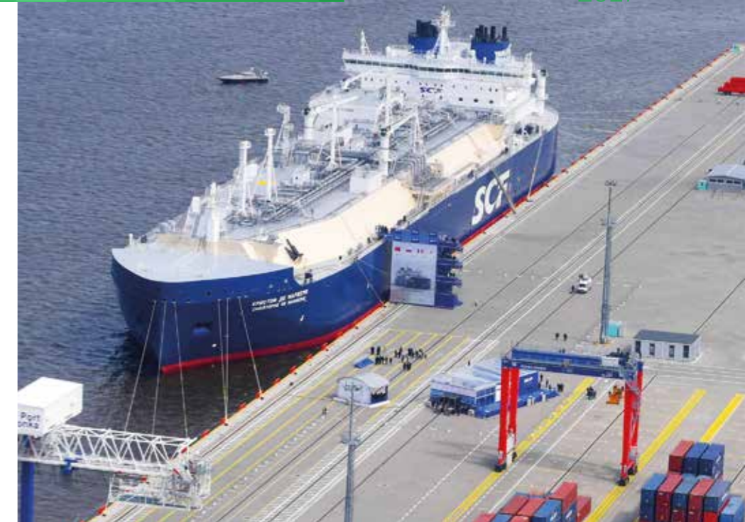
Арктический танкер-газовоз Christophe de Margerie, разработанный для проекта «Ямал СПГ»
